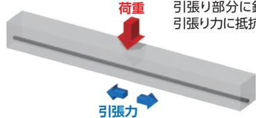
引張り部分に鉄筋を配置して引張り力に抵抗する。
